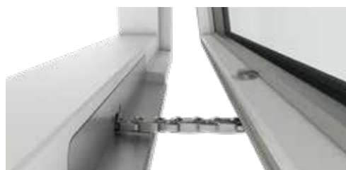
El-motor är inbyggd i karmen och är inte synlig när fönstret är stängt. Levereras med tre olika kedjelängder med öppning 60mm, 210mm eller 440mm.
